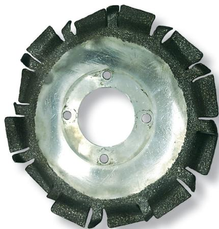
Восстановление и упрочнение рабочих поверхностей фрез диссольверов, используемых для изготовления лакокрасочных материалов, из нержавеющей стали как новых так и бывших в употреблении.
