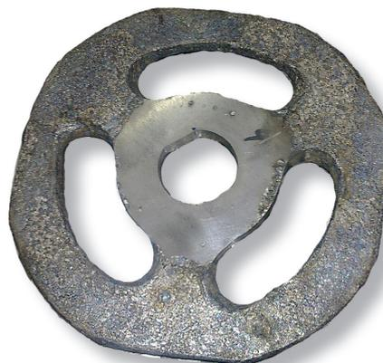
Восстановление и упрочнение рабочих поверхностей фрезы бисерной мельницы из хромистой нержавеющей стали.
