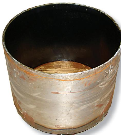
Нанесение защитного упрочняющего керамического слоя на корпус бисерной мельницы
